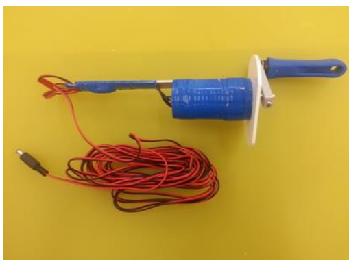
第一種發電裝置：24V 350 rpm 手搖發電機 把插頭拔出及對調插入可變換電極及手搖的方向
