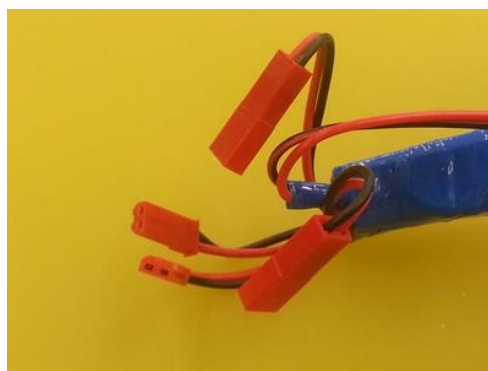
第一種發電裝置：24V 350 rpm 手搖發電機 把插頭拔出及對調插入可變換電極及手搖的方向
