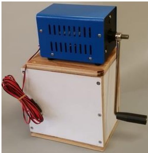
第一種發電裝置：24V 350 rpm 手搖發電機
