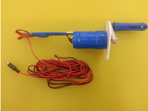
第一種發電裝置：手提式手搖發電機
