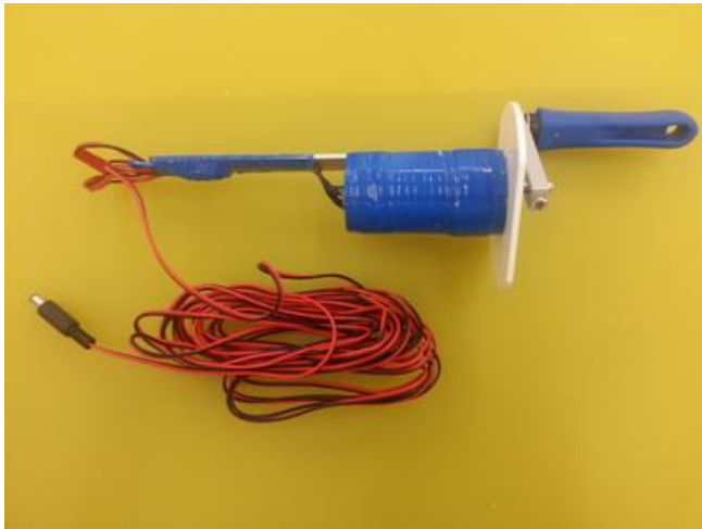
24V 350 rpm 手搖發電裝置
