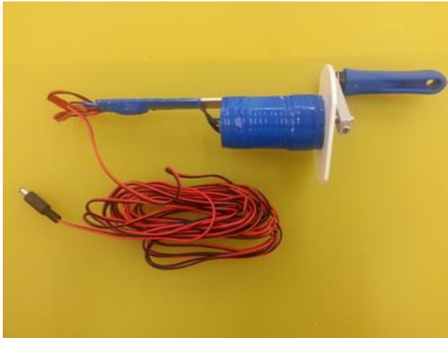
24V 350 rpm 手搖發電裝置
