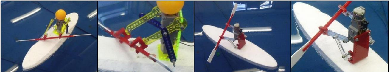
2. 機械人(機械人、船槳及船體)的總體積不能大於長 400mm、闊 400mm、240mm 高。整個船身(不包括槳及支架)必須能穿過附圖長 400mm、闊 80mm 橢圓形範本，不能使用雙體船。
