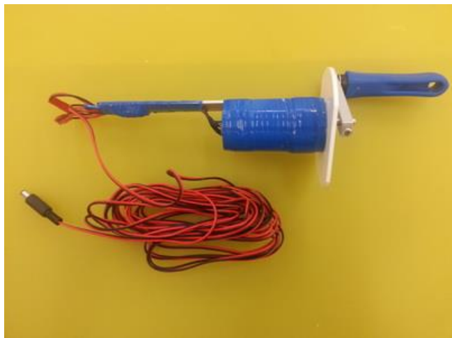
24V 350 rpm 手搖發電裝置
