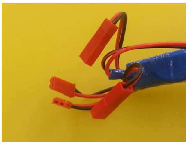
把插頭拔出及對調插入可變換電極及手搖的方向
