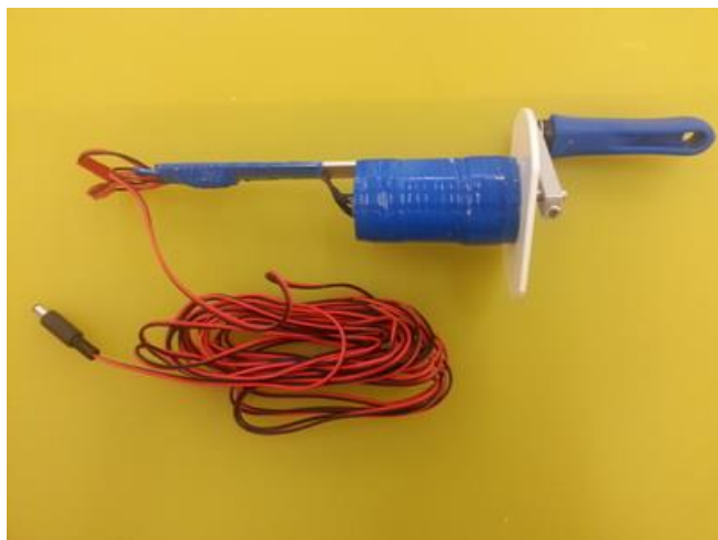
24V 350rpm Hand Generator
