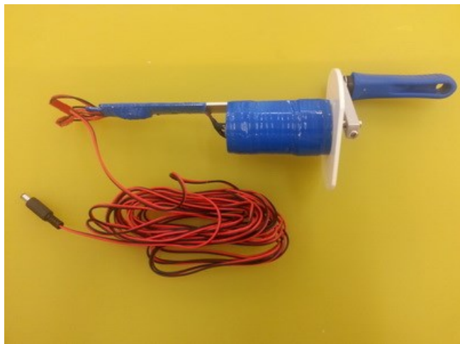
24V 350 rpm 手搖發電裝置
