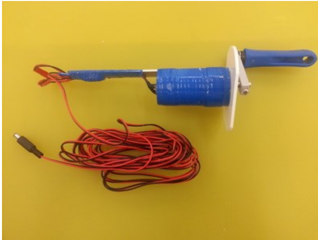
24V 350 rpm 手搖發電裝置
