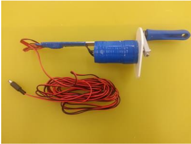
24V 350 rpm 手搖發電裝置
