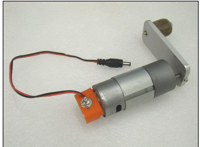
12V 350 rpm 手搖發電裝置(附電極變換開關掣)
