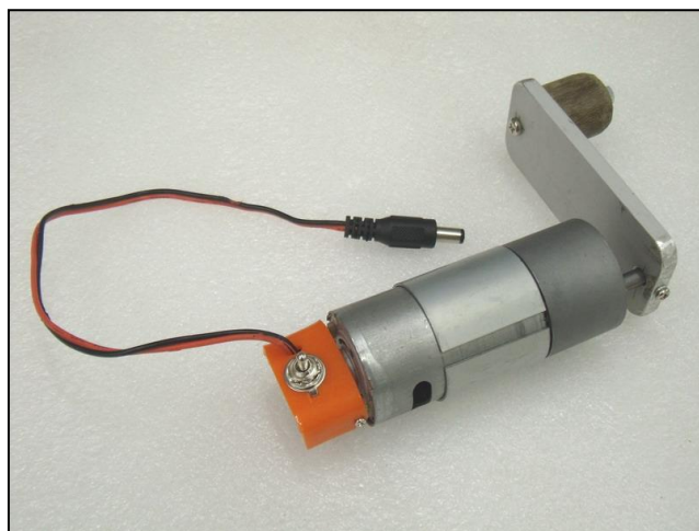
12V 350 rpm 手搖發電裝置(附電極變換開關掣)
