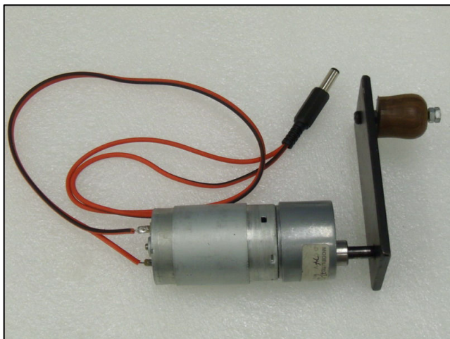
12V 350 rpm 手搖發電裝置
